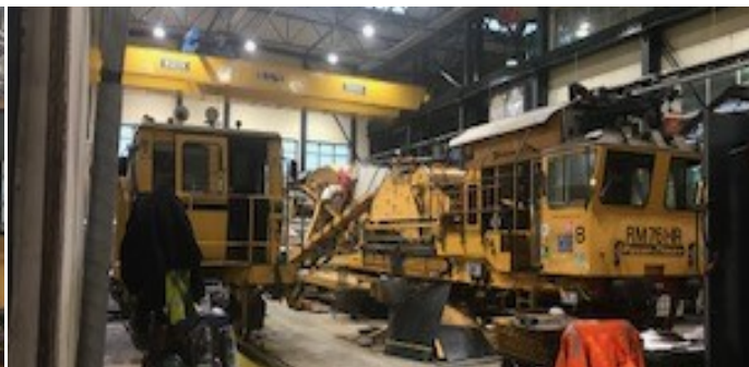
Venstre: Sporjusteringsmaskin. Høyre: Ballastrenseverk.
